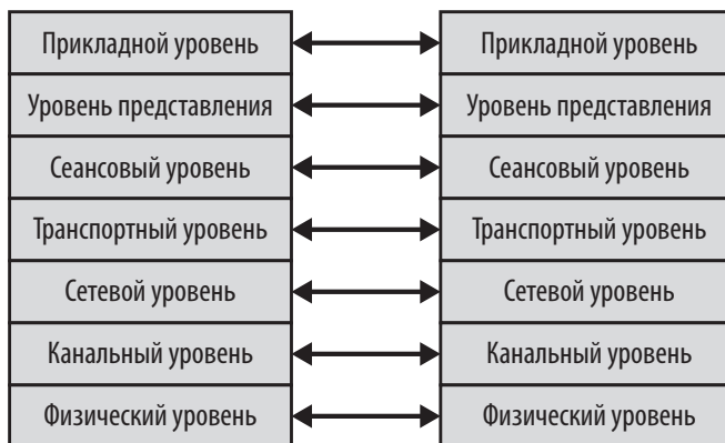
Рис. 2.3. Модель OSI, демонстрирующая взаимодействия между системами
